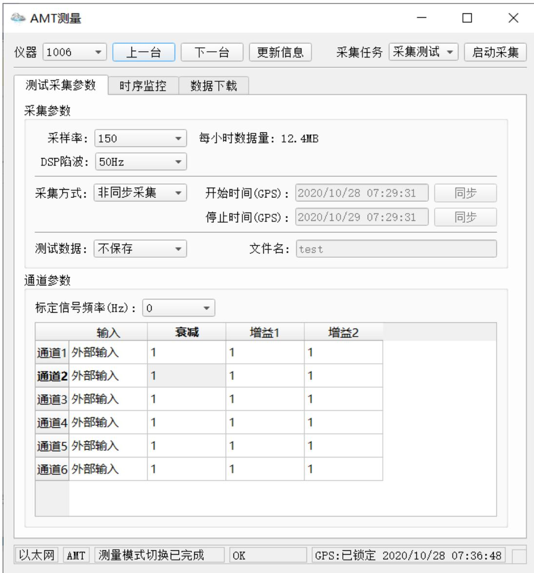
图 4-3. AMT 测量模式的采集测试的参数设置页面
