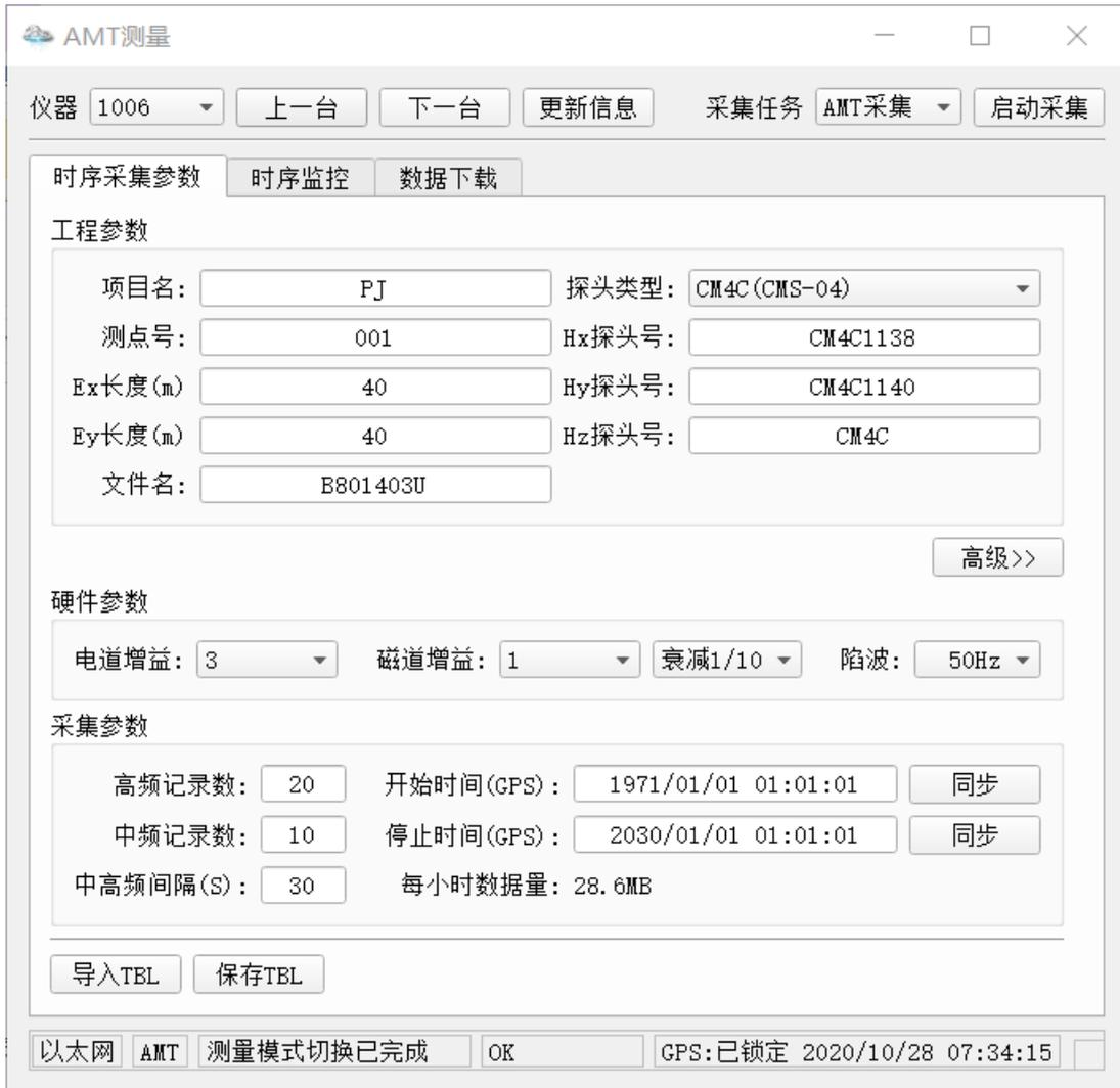
图 4-2. AMT 测量模式的时序采集参数设置页面
