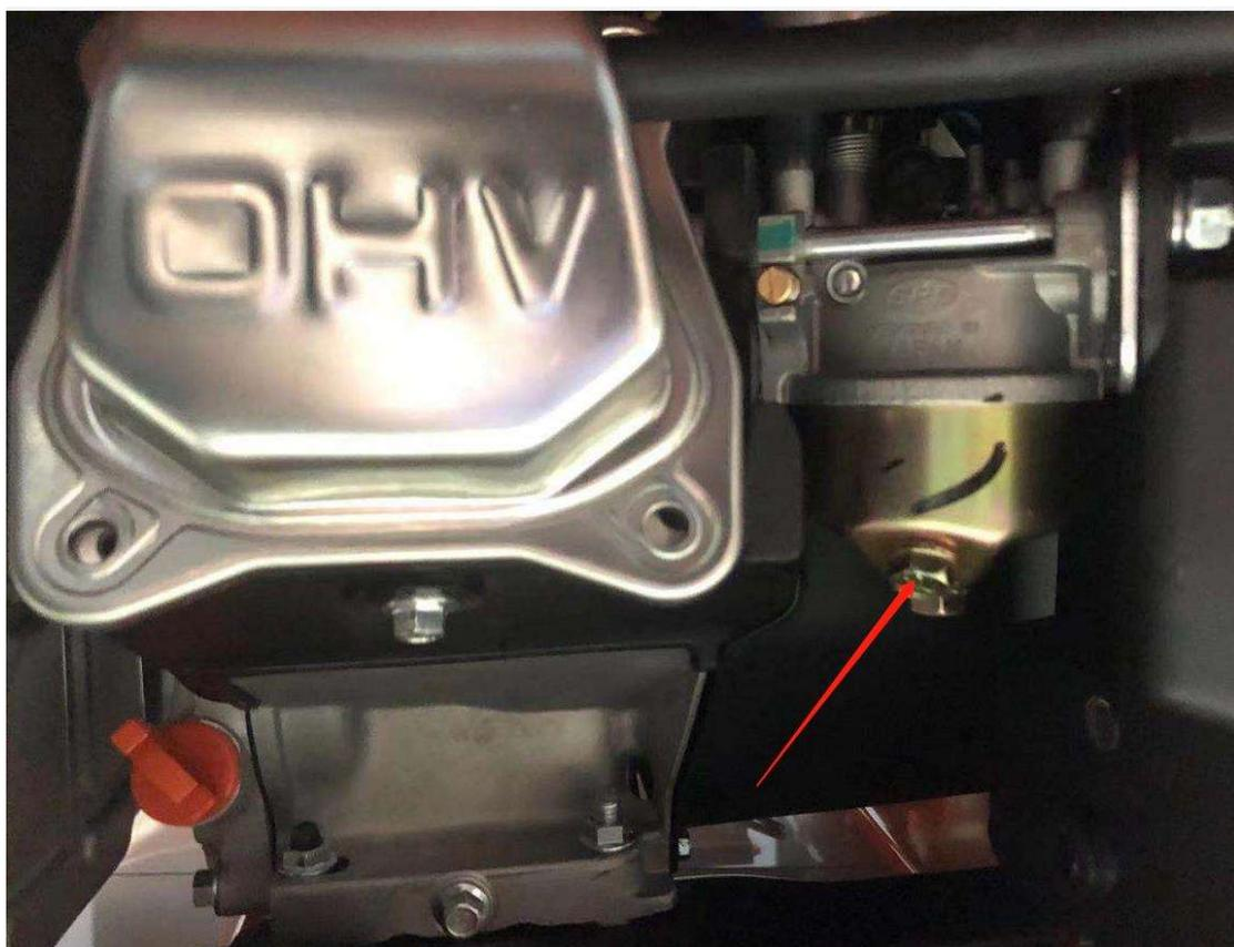
图 2.2 汽油放油螺丝（注意斜面的这颗，不是底部那个!!!）
